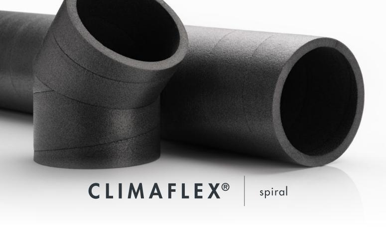
CLIMAFLEX® spiral est une gaine de ventilation en mousse de polyéthylene spiralée. La couche isolante consiste d'une mousse PE de 16 mm de qualité NMC. Un assortiment de différents angles et manches garantit que l'installation peut être adaptée selon les besoins. CLIMAFLEX® spiral est disponible dans les diamètres de tuyau 125, 150, 160, 180 et 200 mm.
