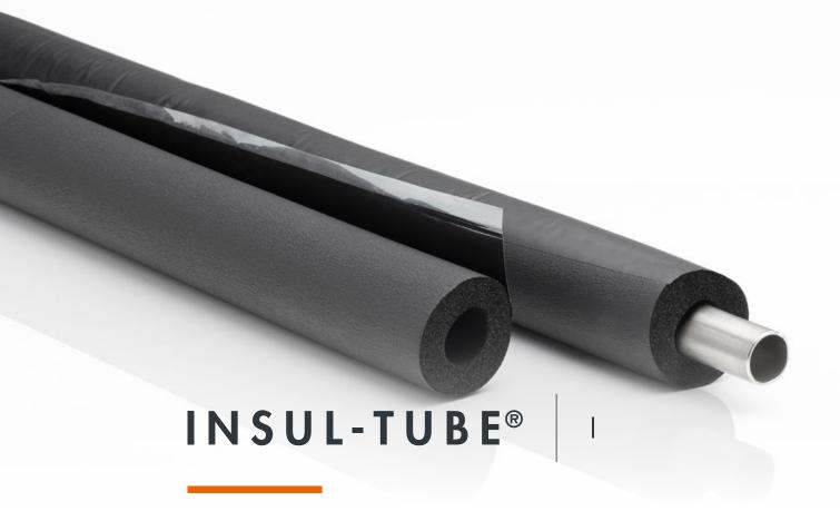
INSUL - TUBE® l'est un matériau isolant souple en mousse à cellules fermées à base de caoutchouc, doté d'une bande de recouvrement avec adhésif en PVC.
