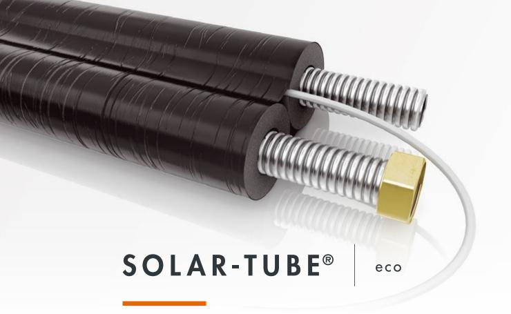
Solution prête à l'emploi pour le raccordement des systèmes solaires. Tubes annelés en acier inoxydable, pré-isolés en EPDM haute température. Intègre un câble électrique pour la connexion directe aux sondes des systèmes solaires thermiques.
