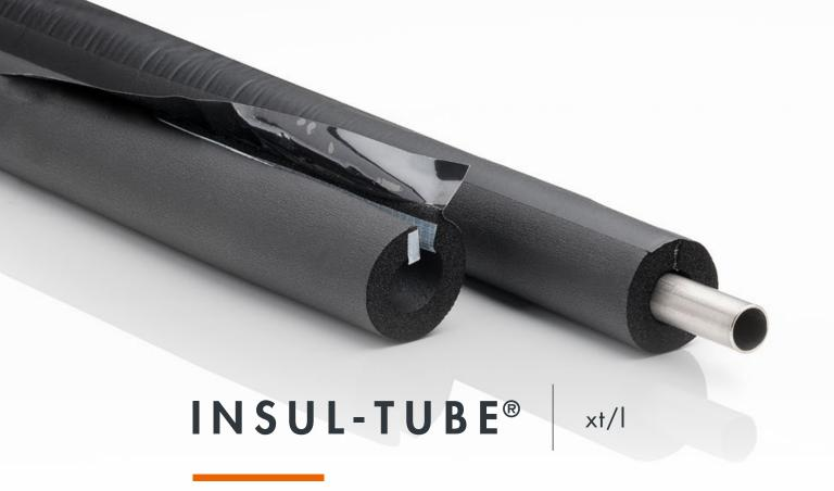
INSUL-TUBE® xt/l est un matériau isolant souple en mousse à cellules fermées à base de caoutchouc, doté d'une fermeture auto-adhésive et d'une bande de recouvrement avec adhésif en PVC.
