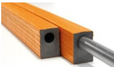
Isolation pour tuyaux à extrusion excentrique, en mousse polyéthylène à cellules fermées, contenant au moins 30% de matières premières recyclées, pourvu d'une membrane extérieure robuste.
