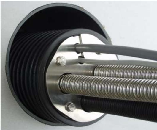
Das Mantelrohr-Abdichtset und das Mantelrohr sind ebenso wie die Edelstahl-Wellrohre und die Kabelschutzrohre an den Dichtflächen zu reinigen. Die Dichtflächen müssen sauber, trocken, fett- und ölfrei sein. Keine fett- oder ölhaltigen Gleitmittel verwenden.
