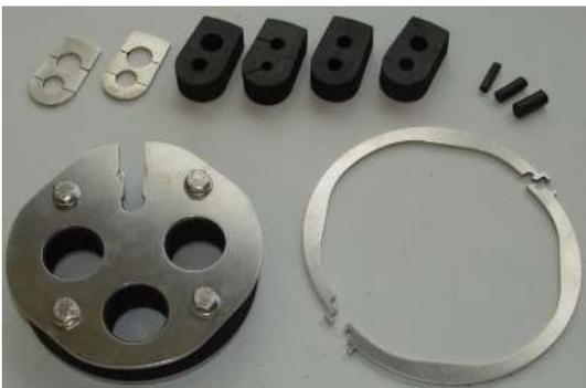
Die Kabeldurchmesser der Steuer- und Fühlerleitungen mit einem Messschieber ermitteln und den passenden Wechseleinsatz je nach Kabeldurchmesserkombination auswählen. Die Durchmesserangaben zu den Bohrungen in den Wechseleinsätzen sind entsprechend eingraviert. Sollte nur eine Steuer- und Fühlerleitung vorhanden sein, muss die frei bleibende Bohrung im gewählten Wechseleinsatz mit dem entsprechenden Gummistopfen verschlossen werden.
