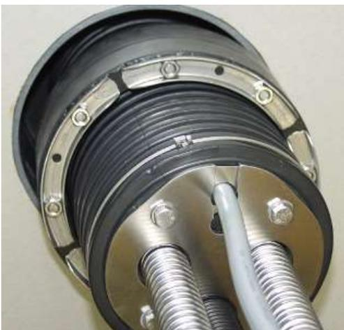
Den Stützring in das erste Wellental beim Dichteinsatz einlegen und auf beiden Seiten mit einer Zange einrasten lassen. Der Stützring kann mit einem kleinen Schraubendreher wieder geöffnet werden. Den Stützring in keinem Fall unter Spannung öffnen nachdem der Dichteinsatz angezogen wurde.
