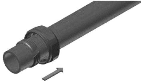
Druckmutter und Klemmring auf das Rohr schieben
